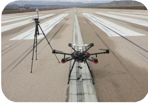
Drone untuk Runway Inspection dan Pre Calibration Check (Ground Inspection) NavAids
