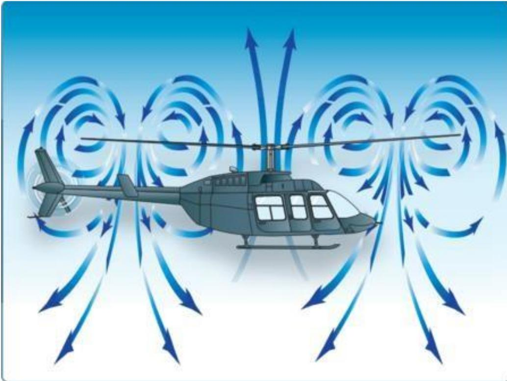
kondisi aerodinamis berbahaya yang mungkin timbul dalam penerbangan helikopter , ketika sistem cincin pusaran menelan rotor , menyebabkan kehilangan daya angkat yang parah
